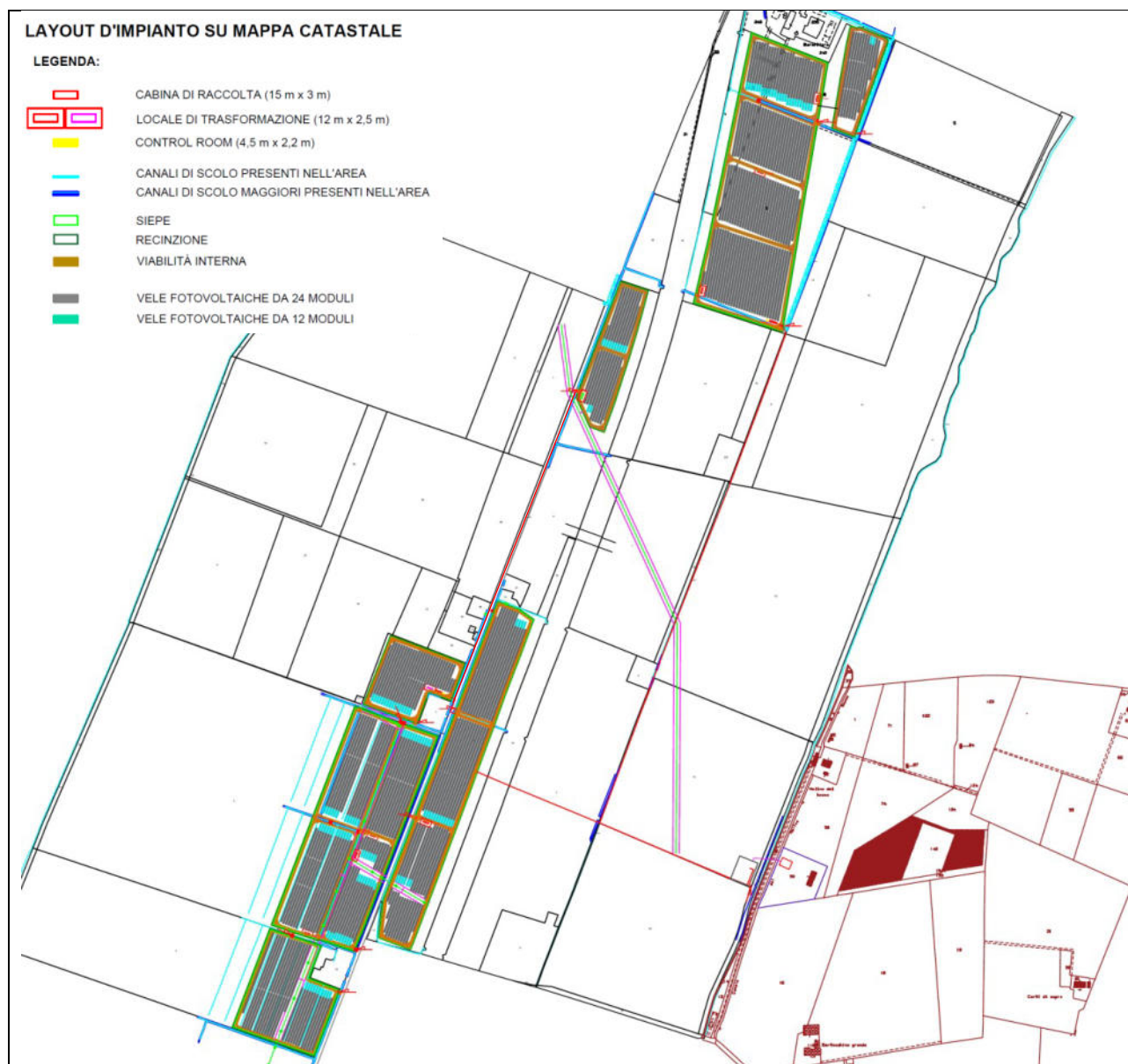
Figura 2 - Inquadramento delle linee di connessione alla rete elettrica esistente su base catastale (fuori scala).
