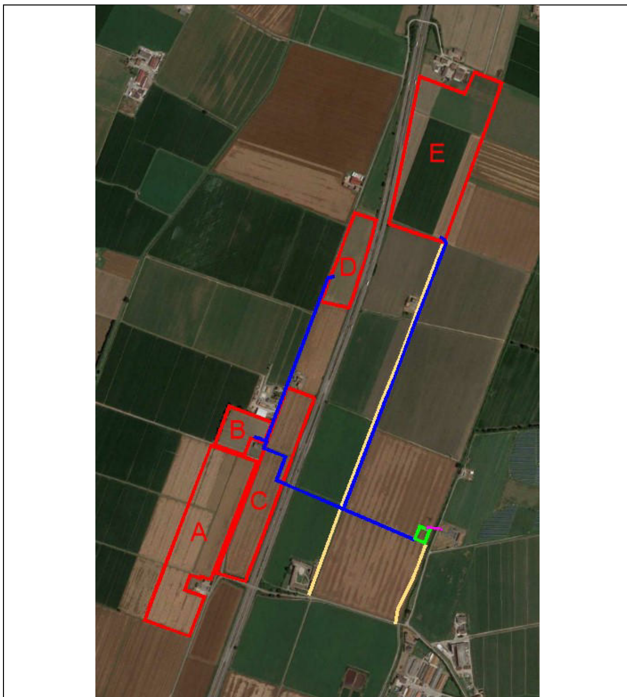
Figura 1 - Inquadramento su foto aerea dell'area di progetto (fonte: Google Earth ®). In rosso sono indicate le aree in disponibilità per la realizzazione dell'impianto fotovoltaico, in blu la linea interrata di connessione elettrica MT, in verde l'area della sottostazione elettrica, in magenta la linea di connessione AT e in giallo le servitù di accesso.
